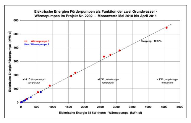
Die elektrischen Energien der Wärmepumpe und der Grundwasser-Förderpumpe stehen in einem guten linearen Zusammenhang: Je größer der monatliche Stromverbrauch der Wärmepumpe, desto höher auch im gleichen Verhältnis der Stromverbrauch der Förderpumpe. Deren prozentuale Anteil beträgt 12,3 % (Steigung der Geraden). Dieser Wert fand auch Eingang in die Bilanzierung der Grundwasser-Wärmepumpe in der Lahrer Kirche.
