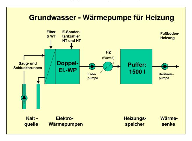
Auf der elektrischen Seite erfasst ein Sonderzähler mit Nieder- und Hochtarifen nicht nur den Stromverbrauch der Wärmepumpen selbst, sondern auch noch die Hilfsenergien für den Not-Heizstab, die Speicherladepumpen, die Regelung und Steuerung sowie für die Umwälzpumpe der Fußbodenheizung, jedoch nicht den Strom für die Grundwasser-Förderpumpe. Die *Erzeuger*-Jahresarbeitszahl berechnet sich wie folgt:
